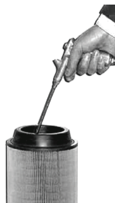
Рис. 11.3 Очистка фильтрующего элемента воздушного фильтра
