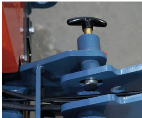
Защелка перемещения рукоятки по высоте
