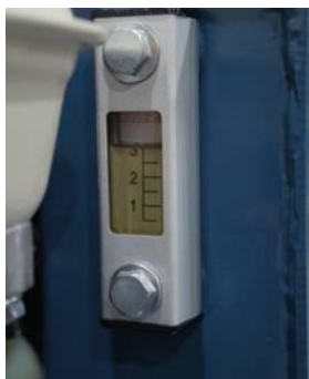
Индикатор уровня масла в гидравлической системе
