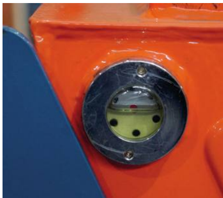
Индикатор уровня масла в гидравлической системе
