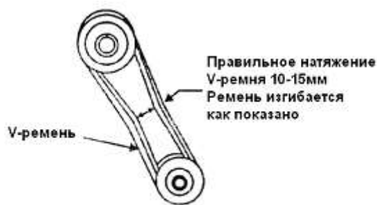
Рис. 2 Натяжение V-ремня
