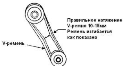
рис. 18 Натяжение V-ремня
